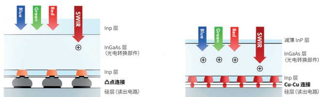
左图:凸点连接;右图:Cu-Cu连接(IMx99x传感器)
